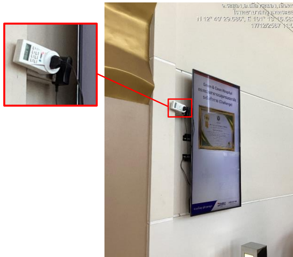
สวิตช์ตั้งเวลา หรือ Time Delay Switch
